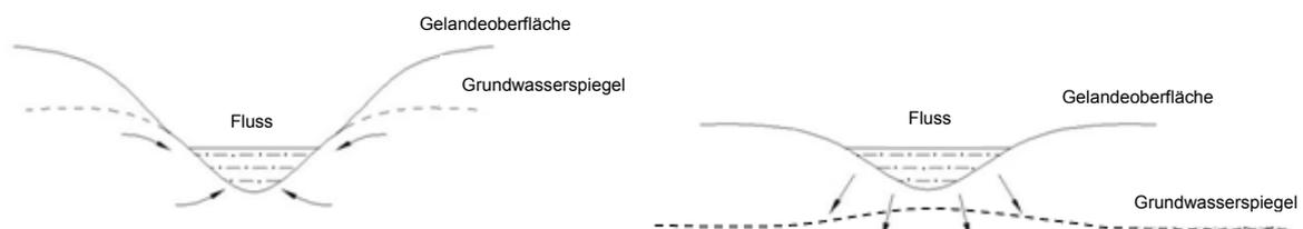
**Abb. 4.24** Austausch zwischen Grund- und Oberflächenwasser durch die gesättigte Zone
