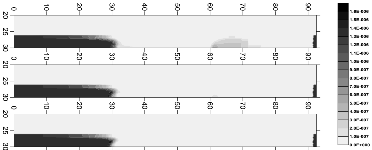
Abbildung 57: 2D-Ansicht der As_{org} -Konzentration [mol/l] bei der parallelen Fahnenanierung Tag 60; Oben: 100 ml FeCl_2 -Dosierung; Mitte: 300 ml FeCl_2 -Dosierung; Unten: 500 ml FeCl_2 -Dosierung.
